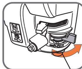
4 Ouvrez la soupape de carburant (sur la droite).
