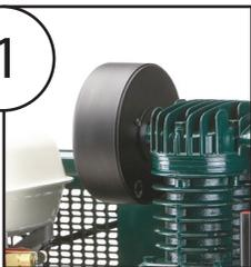
Assurez-vous que le filtre est installé serré à la main et que l'orifice d'admission est exempt de tous débris.
