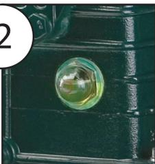
La plupart des compresseurs ROLAIR sont fournis déjà remplis d'huile. Avant tout démarrage, vérifiez le voyant de niveau d'huile et ajoutez-en selon les besoins. Voir dans le manuel la quantité et le type d'huile à utiliser.
