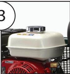
Faites le plein à l'aide d'essence sans plomb ordinaire et à indice d'octane d'au moins 87. Laissez un espace d'air de 2,5 cm (1 po) entre le carburant et le bouchon.
