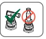
Deje hacia abajo el conmutador de la válvula descargadora, en todo momento.
